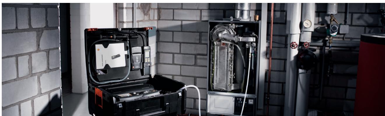
Contrôle de la capacité de fonctionnement automatiquement avec dispositif d'alimentation raccordé à la chaudière au gaz
